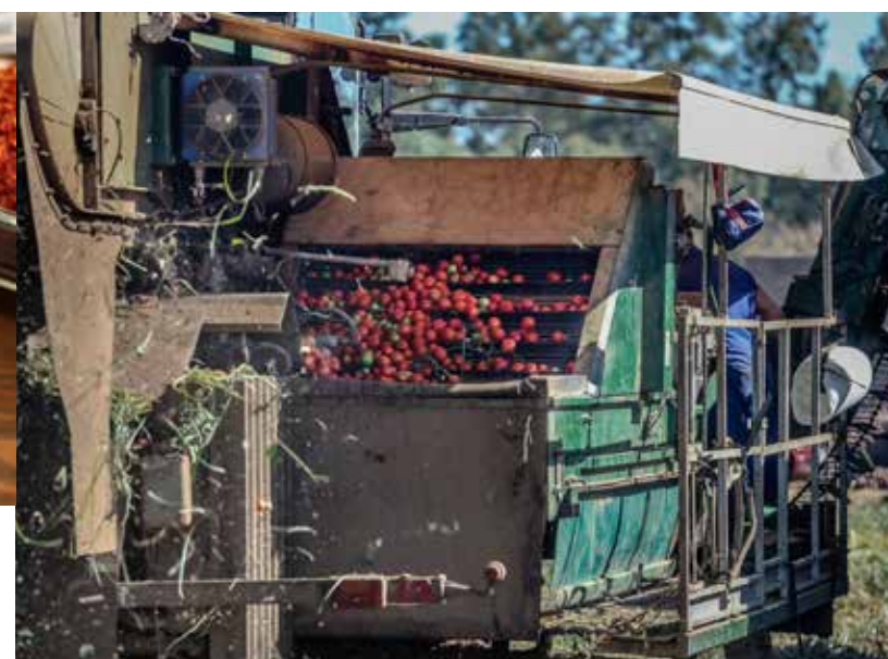
De geoogste tomaten komen in een soort wildwaterbaan terecht waar ze continu, zonder chemicaliën worden gereinigd, en dan gaan ze onder de stamper.
